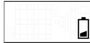
Pilas agotadas, la Válvula ya no funciona. Si ya no tiene la potencia necesaria para cerrar el cuerpo de válvula, puede quedar abierta aunque no esté activada la calefacción.
