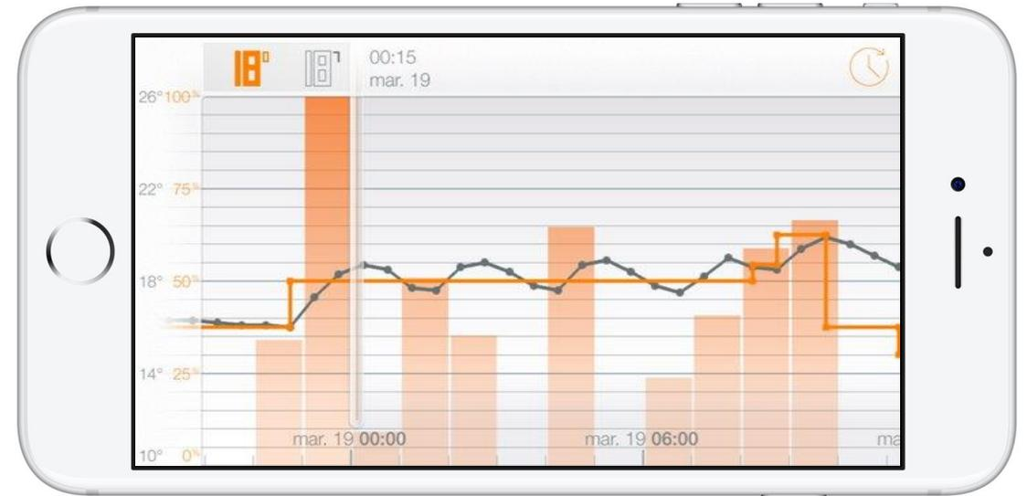
**Nota:** Cuando la temperatura establecida cambia, el Termostato reacciona de forma instantánea a la nueva orden, sin tener en cuenta ningún umbral para activar o desactivar la calefacción.
